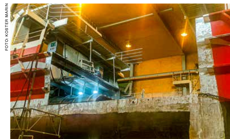
Ombyggnaden av Kostervåg innebar bland annat att fartyget sågades itu och förlängdes med 4,5 meter för att få plats med batterierna.
